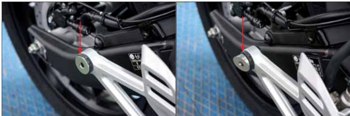
Sostituire il bussolotto indicato con quello fornito
