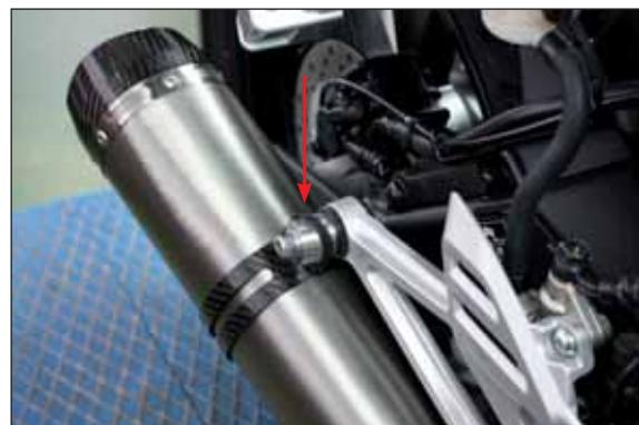
Innestare il terminale Malossi e serrarlo alla pedana mediante fascetta
